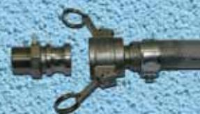
**Raccorderia tubi: consente di smontare il tubo senza attrezzi**
